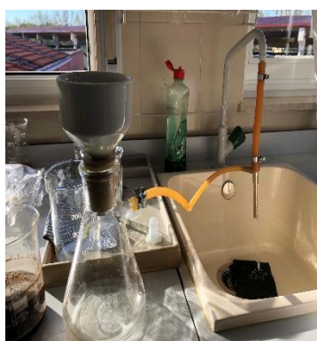
Montaje para filtrado a vacío
